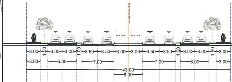
SECTIUNE 1-1 - Profil Str. Valea Cascadeelor - conf. PUZ Coordonator S6
